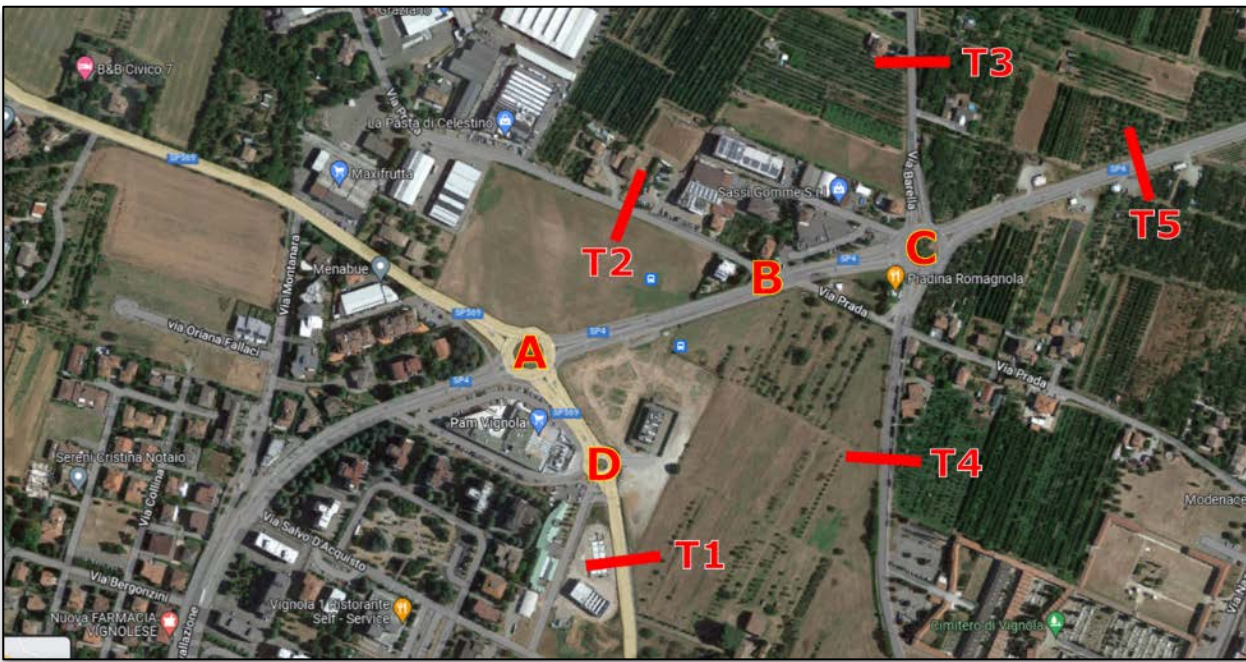
Figura 3.1.10 - Localizzazione delle sezioni di rilievo dei flussi veicolari e delle intersezioni monitorate
